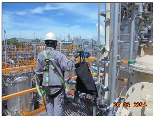
รูปที่ 4.3 การเก็บตัวอย่างคุณภาพอากาศในปล่องระบาย บริเวณปล่องของระบบ VOCs Wet Scrubber (Normal Operation)
