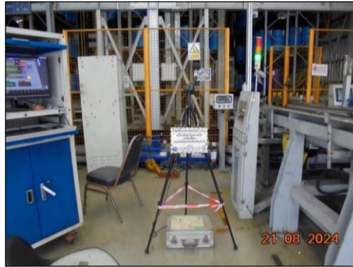
รูปที่ 4.18 การตรวจวัดระดับเสียงในพื้นที่ทำงาน บริเวณ Product / Warehouse
