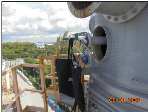
รูปที่ 4.2 การเก็บตัวอย่างคุณภาพอากาศในปล่องระบาย บริเวณปล่องของระบบ Thermal Oxidizer (TO)
